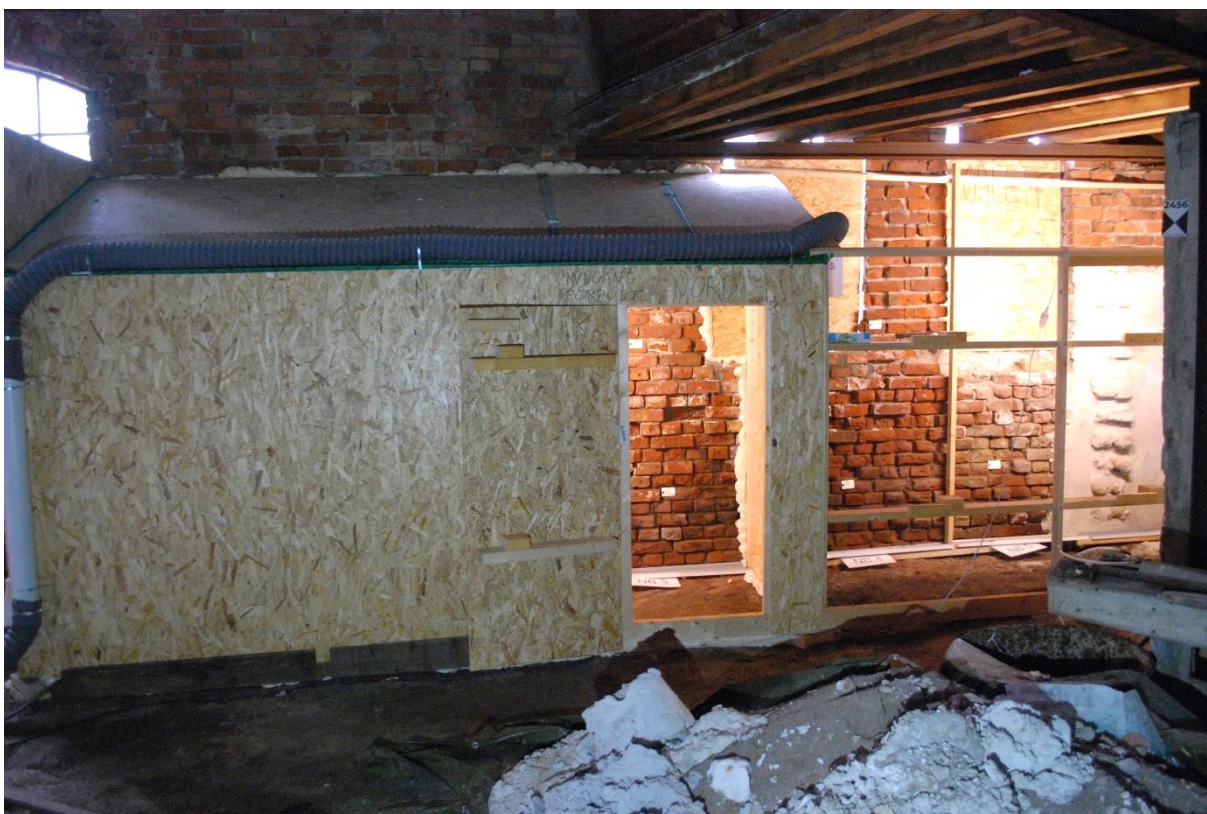
Hovedtestfeltet ved nordveggen i Sodahuset. Vi ser det lukkede, klimatiserte rommet og det åpne til høyre. I hvert «rom» er det tre delfelter: ubehandlet, offerpuss og saltkonvertering.
